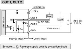
ZD1, ZD2: Surge absorption zener diode Tr1, Tr2 : NPN output transistor
